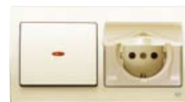
Breaker-switch with indicator Lamp and safety socket base 184624 -ALX Interrupteur-commutateur avec signal lumineuse et base de prise sécurité 16A 250 V~ Pack / Emb 5
